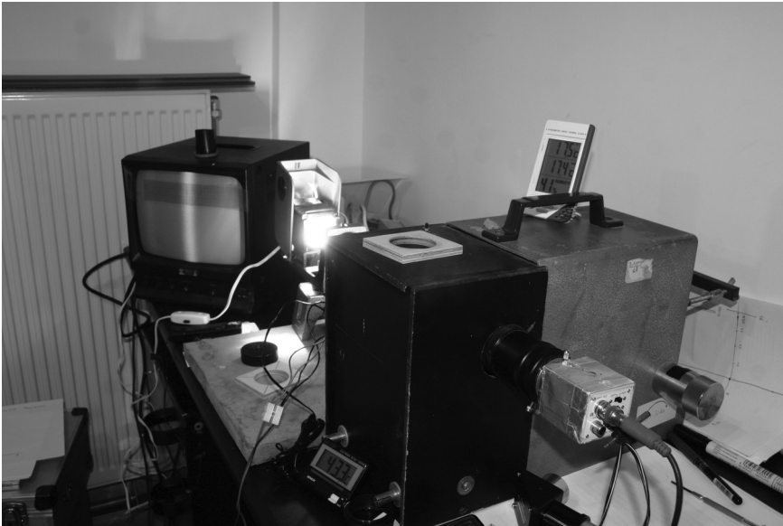
ΦΩΤΟ 2: ΤΜΗΜΑ ΤΗΣ ΟΠΤΙΚΗΣ ΔΙΑΤΑΞΗΣ ΤΟΥ ΓΡΑΦΟΝΤΑ (φασματογράφος, κάμερα, θόνη)
